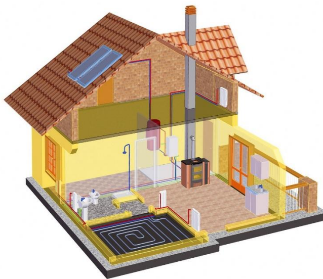
Система отопления частного дома
