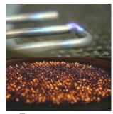
Альтернативой являются котлы с функцией модуляции горелки. Наиболее распространенный вариант – это ступенчатая модуляция, когла при необходимости снижается, мошность например, на 25 - 75% максимальной. В наиболее продвинутых моделях реализована функция непрерывной плавной модуляции. Именно работает инновационная горелка поверхностного горения FLATFIRE.
