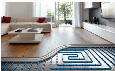
Уточним, что тут речь идет о водяных теплых полах, которые представляют собой систему изогнутых медных, металлопластиковых трубопроводов или труб из сшитого полиэтилена, спрятанных в стяжке пола. По этим трубам циркулирует теплоноситель, нагретый в отопительном котле. Как правило, их используют как дополнение к традиционной радиаторной системе отопления.
