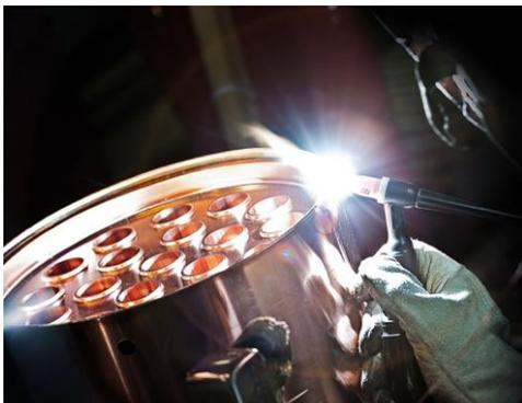
Также весьма ценна высокая устойчивость меди к коррозии. В процессе эксплуатации медного теплообменника на поверхности металла появляется тонкая, но плотная плёнка оксида, которая защищает нижележащие слои от коррозии.
