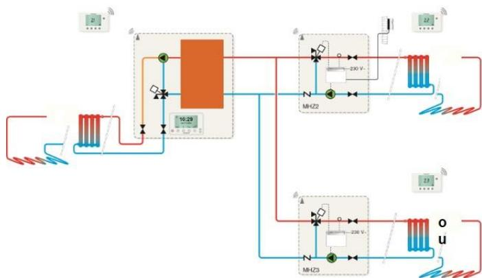
Обычно задача устройства и регуляции независимых контуров отопления решается с помощью распределительных гребёнок (коллекторов), дополнительных циркуляционных насосов и блоков управления. Более технологичное решение – это использование настенных бытовых котлов FRISQUET, которые имеют резервные выходы из теплообменника для
